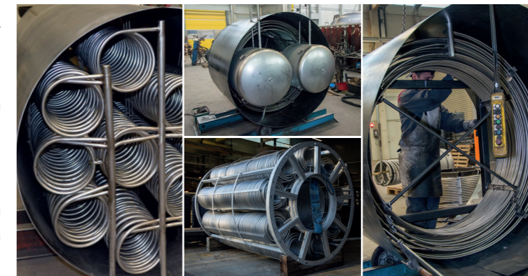
Anlagenbeispiele – WRG-Speicher, 2.850 ltr., Höhe 3.820 mm, 3 WRG-Tauscher und 1 Wellrohrtauscher (links u. mitte unten); WRG-Speicher, 3.600 ltr., Höhe 2.070 mm, 2 WRG-Tauscher und 2 Integralboiler (mitte oben u. rechts).
